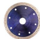
Die Diamant - Trennscheibe Typ Fliese Titan blau verfügt über eine hochwertige Bindung mit flanschverstärktem Stahlkern. Die Scheibe ist turbogesintert und durch ihren dünnen Diamantbelag von 1,2 mm speziell für extrem hartes Feinseinzeug geeignet.
