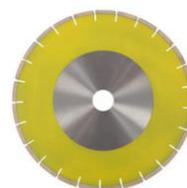
Die Diamant-Trennscheibe Typ MA für Marmor besteht aus einer hochwertigen Bronzebindung für exzellente Schnitte in allen Weichgesteinen. Die Schnittqualität wird schon bei den ersten Schnitten erreicht, so dass ein langes Einschneiden nicht notwendig ist. Der Sandwich-Kern (SDW) reduziert die Geräusentwicklung während des Schneidens. Gute Standzeit!
