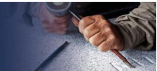
**DIAMONT-DL-Riffler mit Hartmetall-Einzelplatten - Schaft 6a für Hartgestein**
