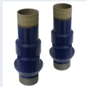
CNC Dia-Hohlbohrer D 35 mm 2500 - 2800 U/min Bohrvorschub: 15 - 20 mm/min
