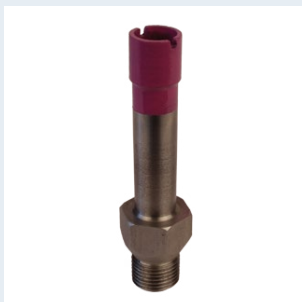
Dia-Stufenfräser 20 x 15 mm Lam 1 8.000 - 9.000 U/min Absenkung: 0,3 - 0,4 mm Vorschub: 800 - 1200 mm/min
