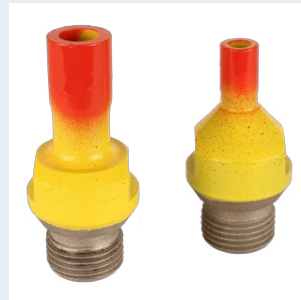
Dia-Stiftfräser D 10 + 16 mm Lam 8500 - 10.000 U/min Absenkung: 0,3 - 0,5 mm Vorschub: 800 - 1200 mm/min
