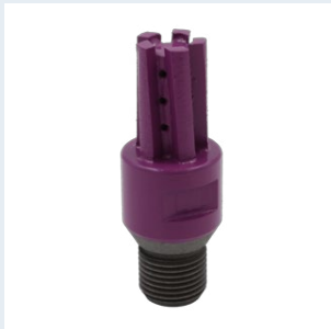
Dia-Fingerfräser 20 x 35 mm Lam LD 3800 - 4200 U/min Vorschub: 120 - 160 mm/min
