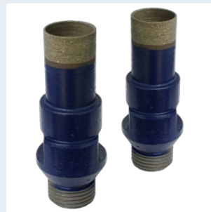
CNC Dia-Hohlbohrer D 35 mm 2500 - 2800 U/min Bohrvorschub: 15 - 20 mm/min
