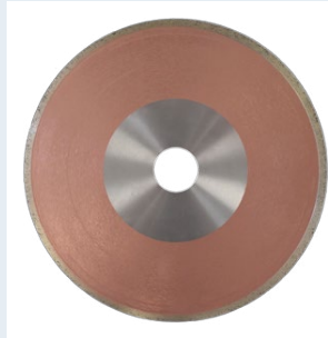
Dia-Trennscheibe Lam LD Umfangsgeschwindigkeit 40 - 42 m/sek D 400 mm: ca. 1900 U/min Vorschub: 0,8 - 1,5 m/min Neolith ab 8 mm
